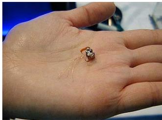
Fig. 1 細管郡外部検査試作システム
