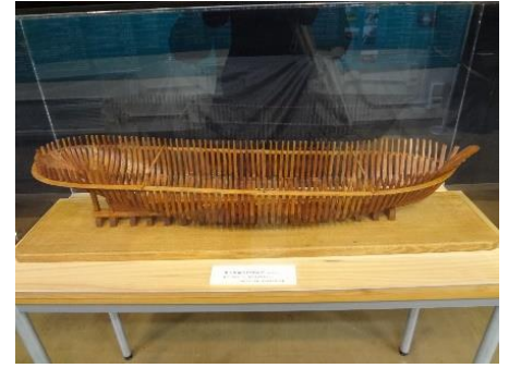
第五福竜丸肋骨構造 (都立第五福竜丸展示館所蔵 著者撮影)
