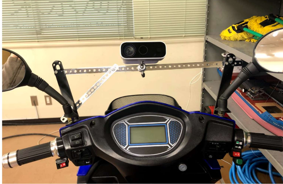
図 4-1-2 深度カメラの搭載方法 ver1
