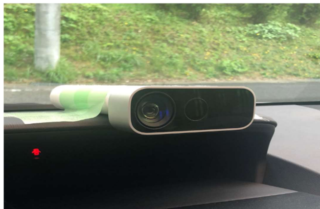
図 3-1-1 計測に使用した深度カメラ (Azure Kinect DK)
