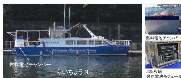
図1 らいちょう N と燃料電池モジュール
