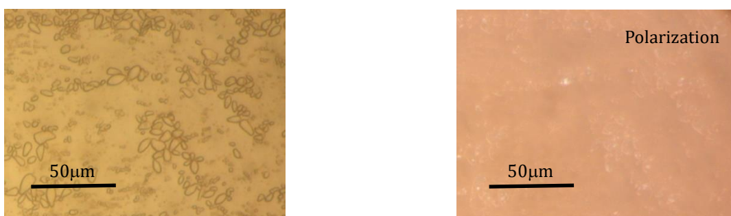
Fig.4-3(d) 冷却プロセス時の PPP-OOO (O/W エマルジョン状態) [173K]
