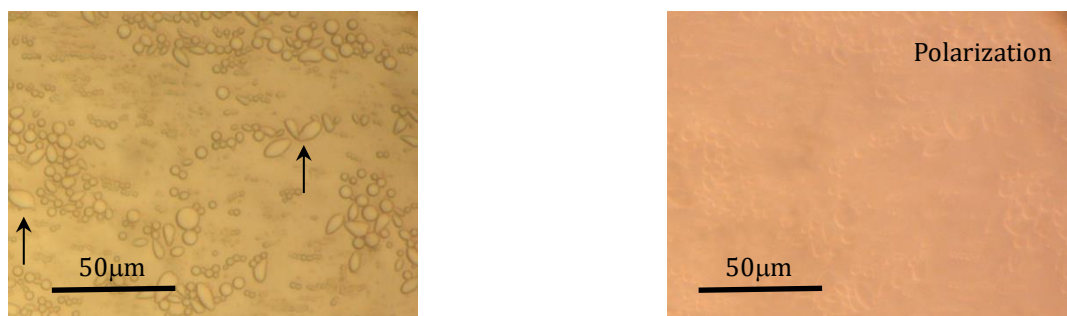
Fig.4-3(b) 冷却プロセス時の PPP-OOO (O/W エマルション状態) [273K]
