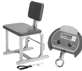
写真 7 膝伸展筋力測定（左：片脚用筋力測定台（T.K.K.5715）・右：テンションメーターD（T.K.K.5710））
