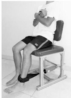
写真 6 膝伸展筋力測定 (左 : 片脚用筋力測定台 (T.K.K.5715)・右 : テンションメーターD (T.K.K.5710) )
