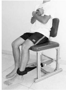
写真 7 膝伸展筋力測定（左：片脚用筋力測定台（T.K.K.5715）・右：テンションメーターD（T.K.K.5710））
