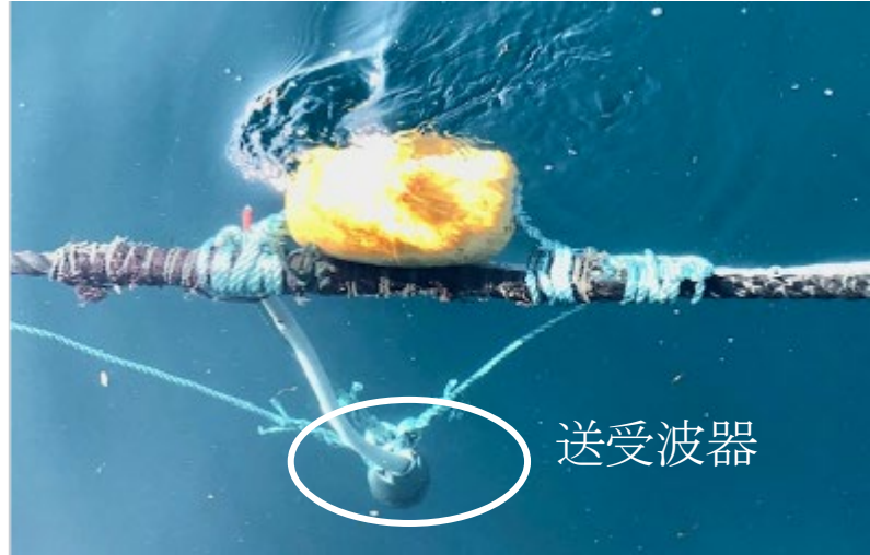
Fig.6 定置網用魚群探知機の海上ブイ(左)と送受波器(右)
