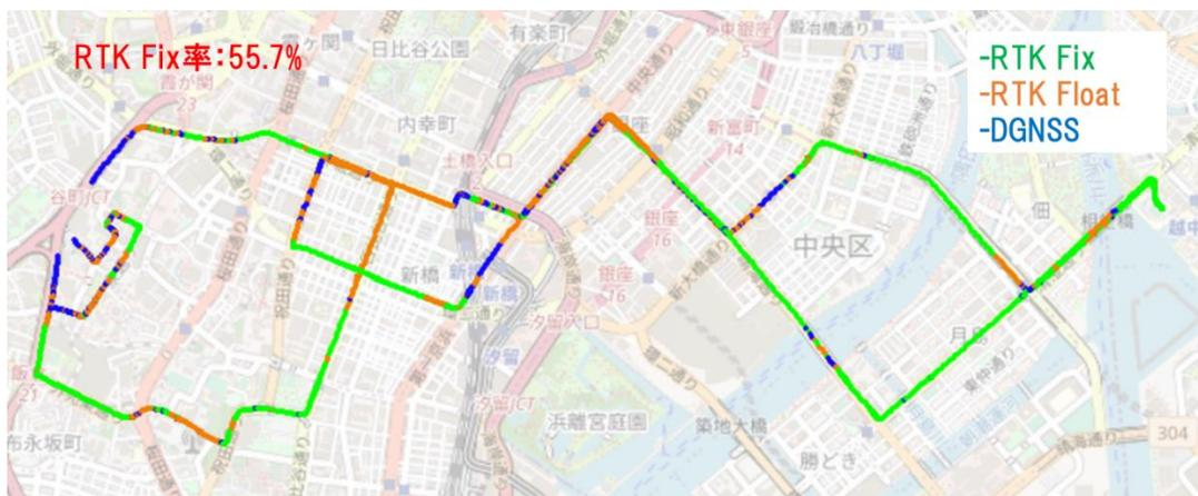
図 4.1-1 走行試験における F9P の RTK Fix 結果の例
