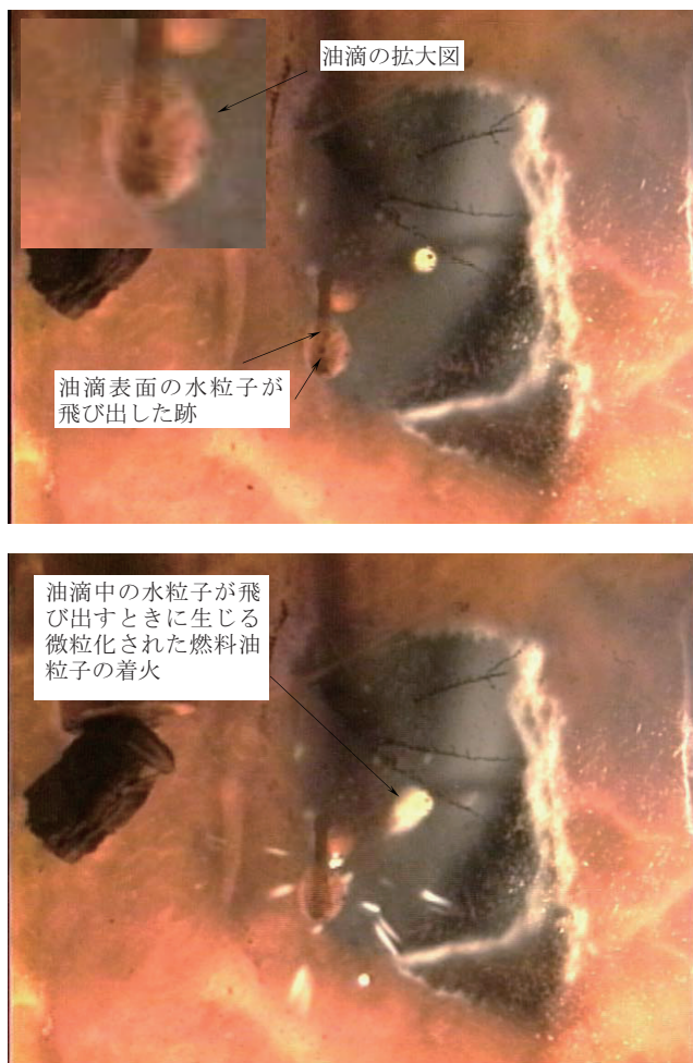
図3 着火前における乳化燃料油中の水滴の飛び出し (上の写真) と微粒化燃料油粒子の着火 (下の写真) ( \phi : 20% \epsilon : 2% E5 T_a : 1100K p_a : 0.1MPa)
