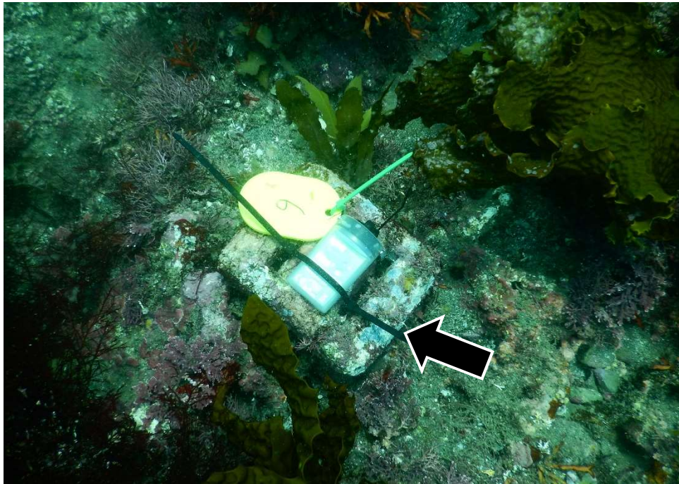
Fig. 4 水温、照度の計測のため設置したロガーの設置状況
