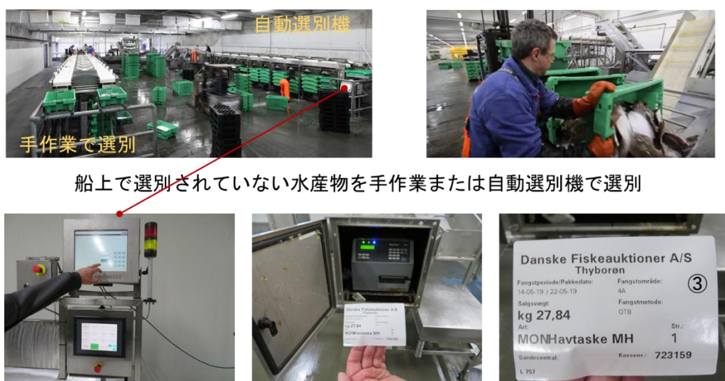
船名、漁獲水域、魚種、規格等の情報を自動選別機や選別台の計量計のパネルに入力し、漁獲情報と計量結果を含めて印刷出力したラベル③を魚箱に投函および貼付
