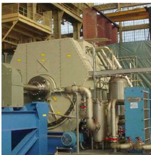
図 1-6 36.5MW超電導船用回転機 [5]
