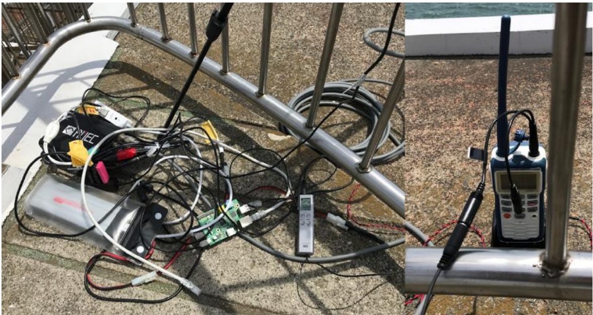
図 28 国際 VHF 通信と AIS 情報を収集するシステム (左 : AIS 受信機・Raspberry Pi・ボイスレコーダー・バッテリー、右 : 国際 VHF)
