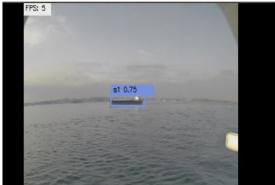
図 33. 動画に対して大型船の認識結果 75%確率の漁船 (s1) 実際は他の大型船であるが、漁船と認識された。これは誤分類である。
