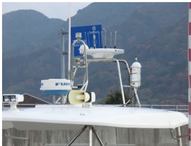
図 3.5 すばる搭載機器（GNSS コンパス，AIS 他）
