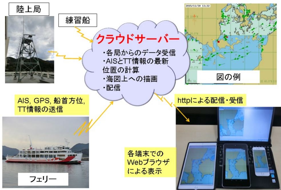
図 3.34 プロトタイプシステムの概略構成
