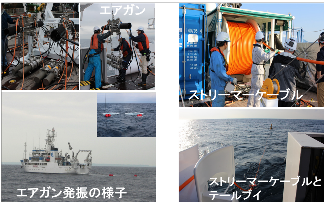
図2 海底音波探査装置と神鷹丸を用いた新規実習準備の様子
