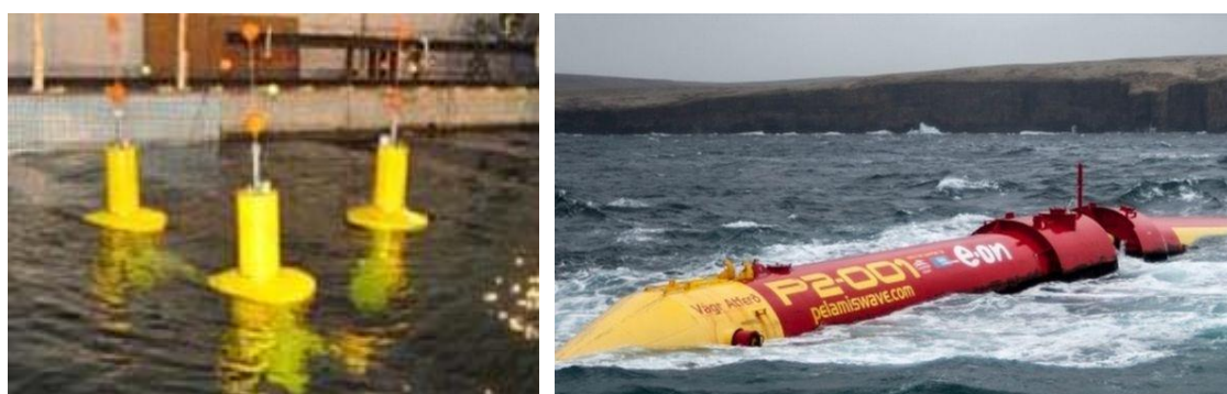
Fig. 1-4 Oscillating bodies type wave energy converters (left: point absorber by MES, right: Pelamis). (出典：三井造船昭島研究所ホームページおよび EMEC ホームページ)
