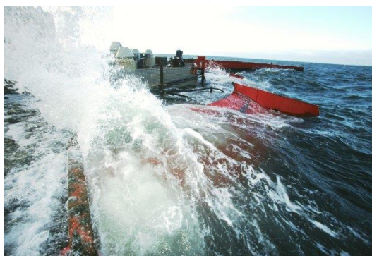
Fig. 1-5 Overtopping type wave energy converter. (出典：Wave Dragon Aps. 社ホームページ)
