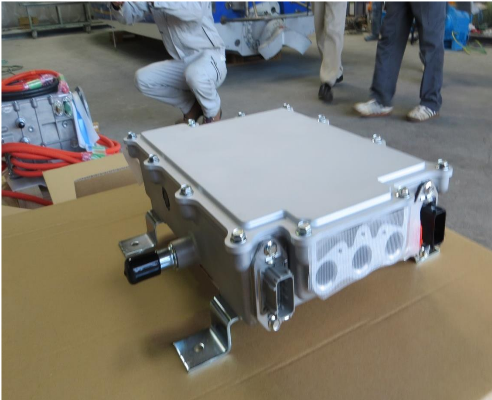
図 2.14 インバータの外観
