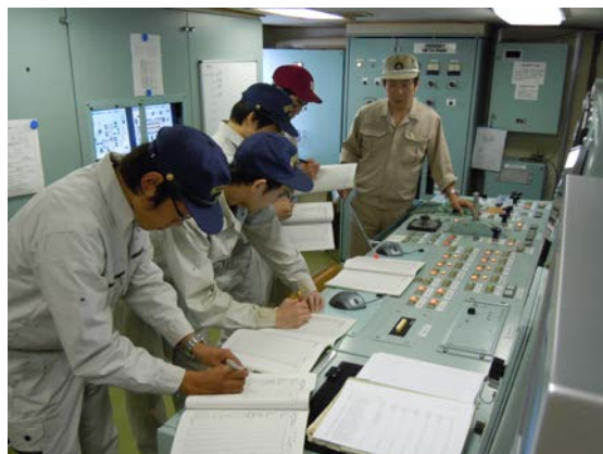
Fig.1.2 機関特性測定実験
