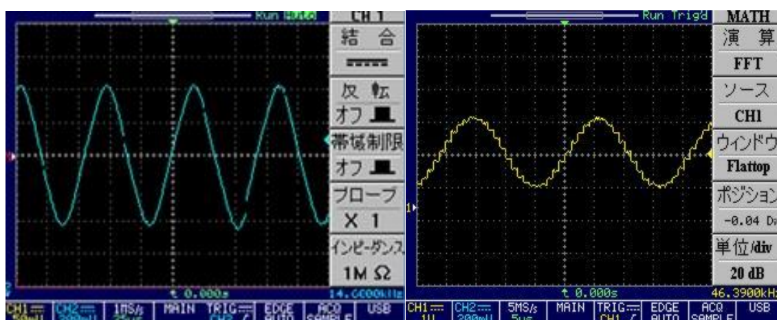
Fig. 5-2-11 Arduino Due による信号発生結果
