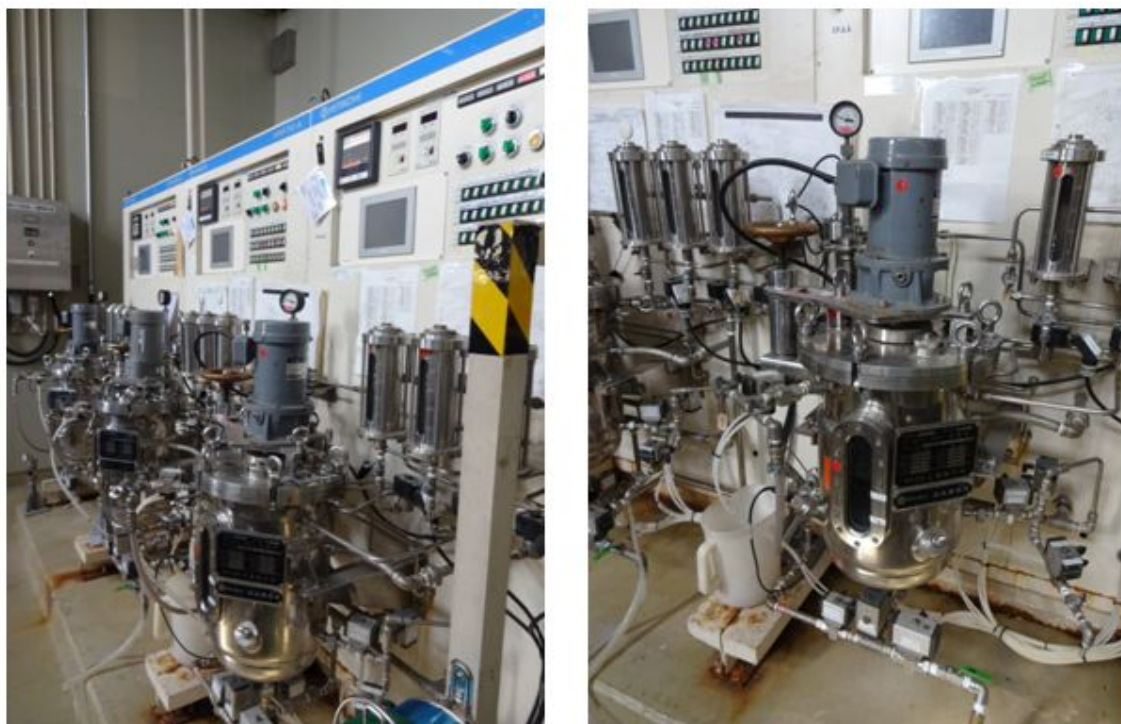
Fig. 5-1 サッポロビール（株）価値創造フロンティア研究所研の Jar Fermentor (30 L) （全景写真）
