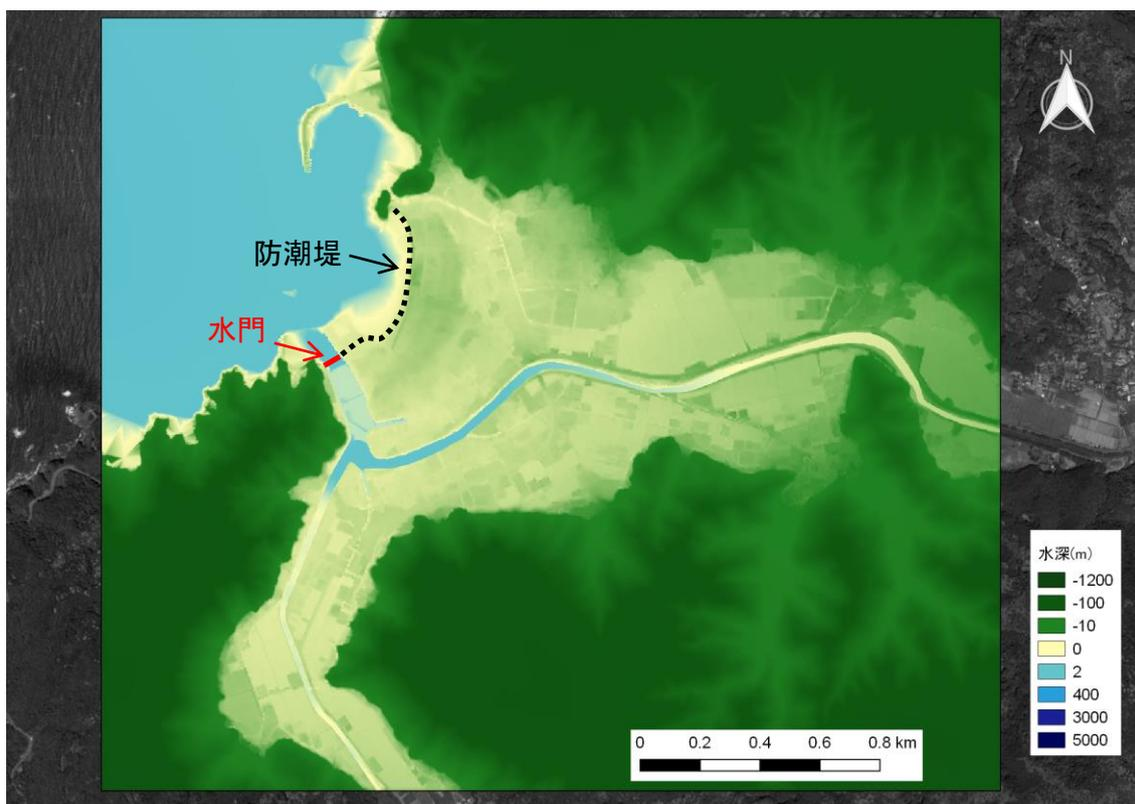
図 4-1-1 津波浸水計算に用いた水深分布図（第6領域）
