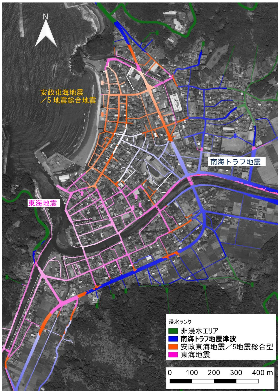
図 4-25 浸水確率ポテンシャルマップ（鉛直避難なし、 $H=7.5\text{m}$ 、高潮位）
