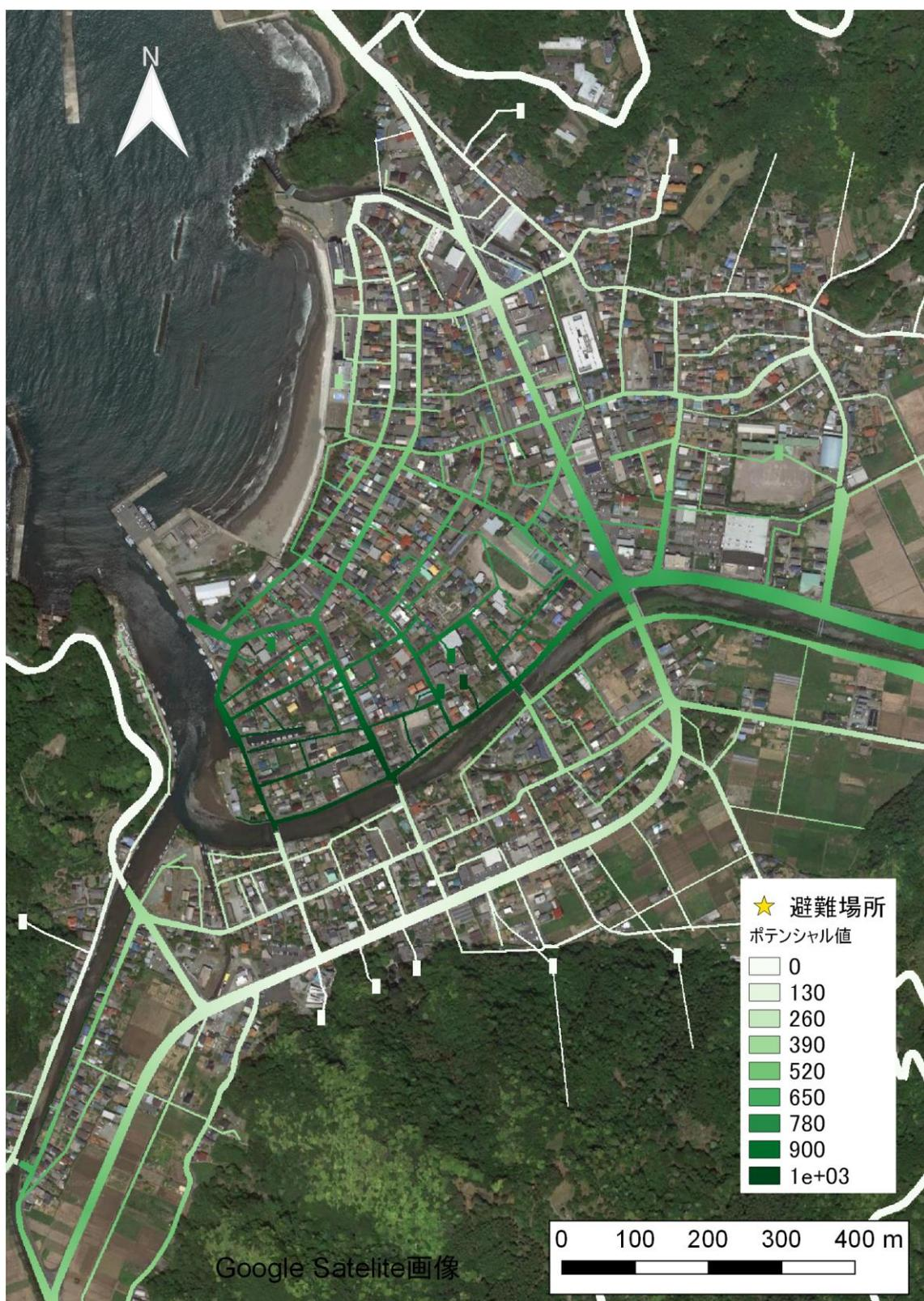
図 4-23 最短距離探索ポテンシャルマップ（鉛直避難なし、 $H=7.5\text{m}$ 、高潮位）
