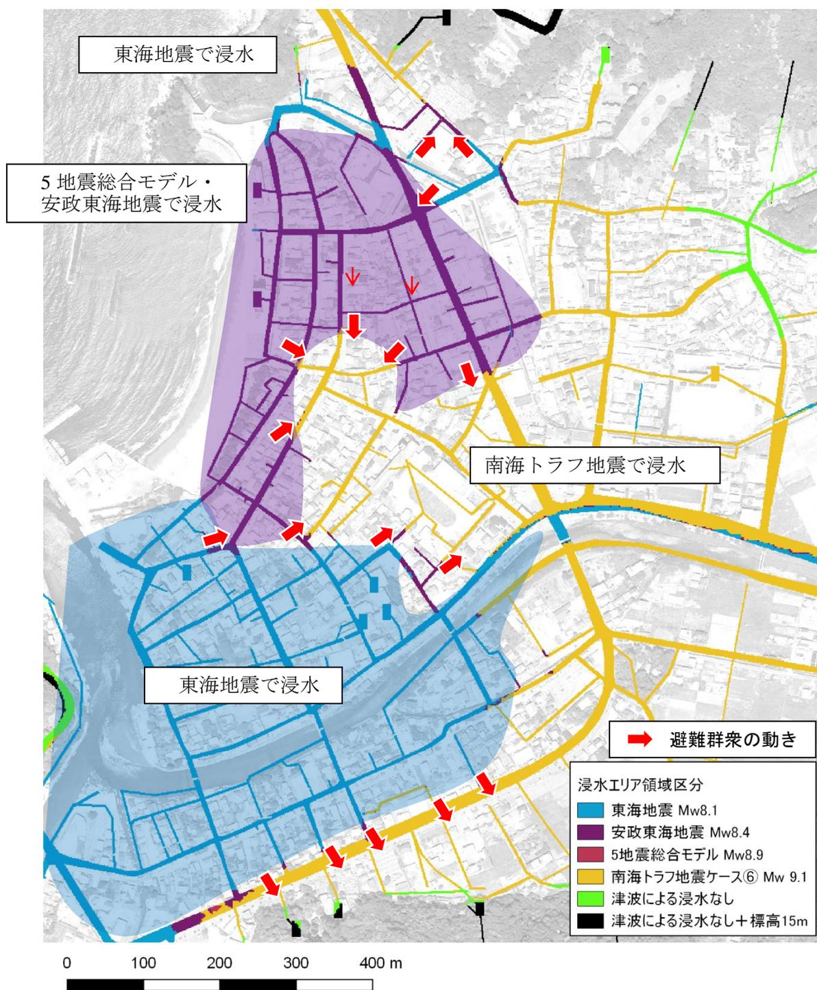
図 3-1 1 浸水解析結果に基づき分けた区分図
