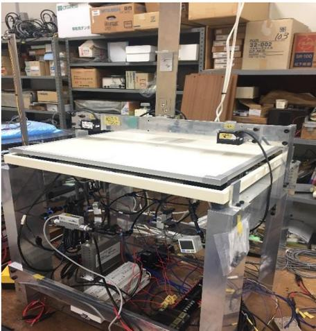
図4 本研究で使用する空圧式除振台
