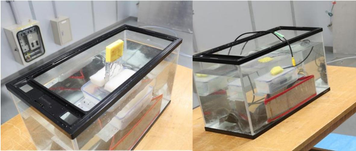
図 3-16 誘電体を導電体で被覆した場合および同軸ケーブルを用いた場合
