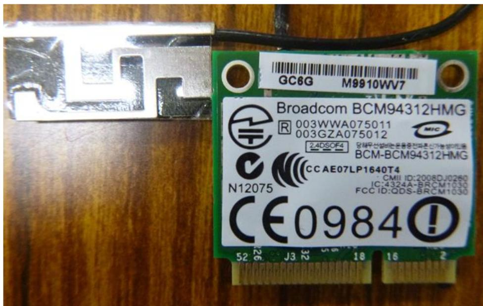
図 3-12 「空中線系」と「高周波部及び変調部」の実例
