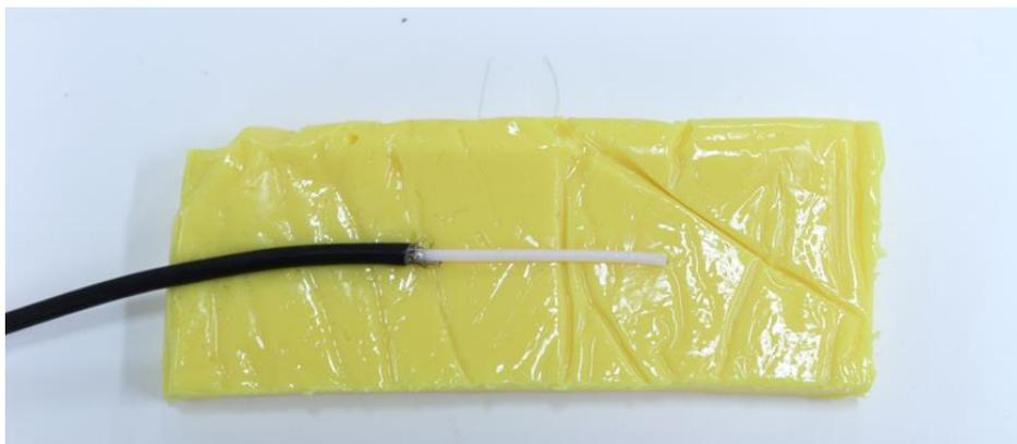
図 3-7 水中ユニットに接続する誘電体および同軸ケーブル
