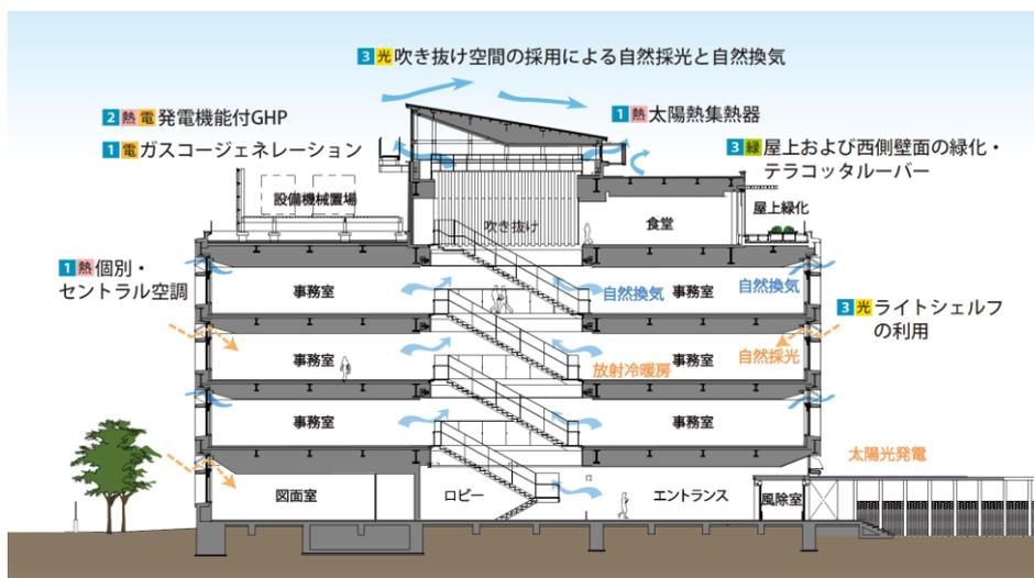
図 5.4 吹き抜けを利用した自然換気を採用した例
