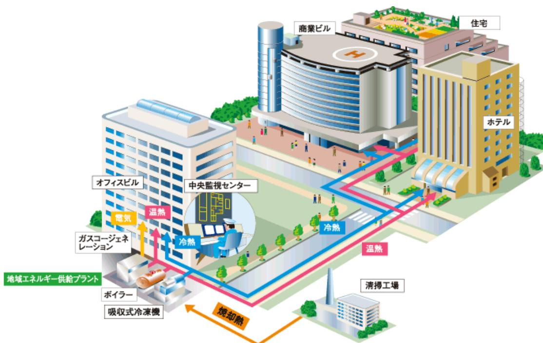
図 2.3 地域冷暖房方式の例
