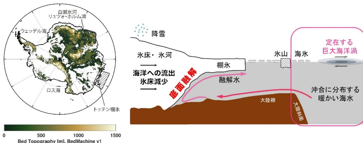
図 2：(左) 海面に対する南極氷床底面の標高。白抜きの領域は、氷床基盤が海面よりも下に位置する領域を示す (Morlighem et al., 2020)。(右) 海洋による氷床末端部・棚氷の融解プロセスを示す模式図。
